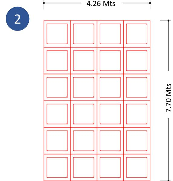
Las Cúpulas No. 3 y 4 serán completadas con piezas existentes desmontadas de las cúpulas No. 1 y 2 (Acrílico Piramidales)
