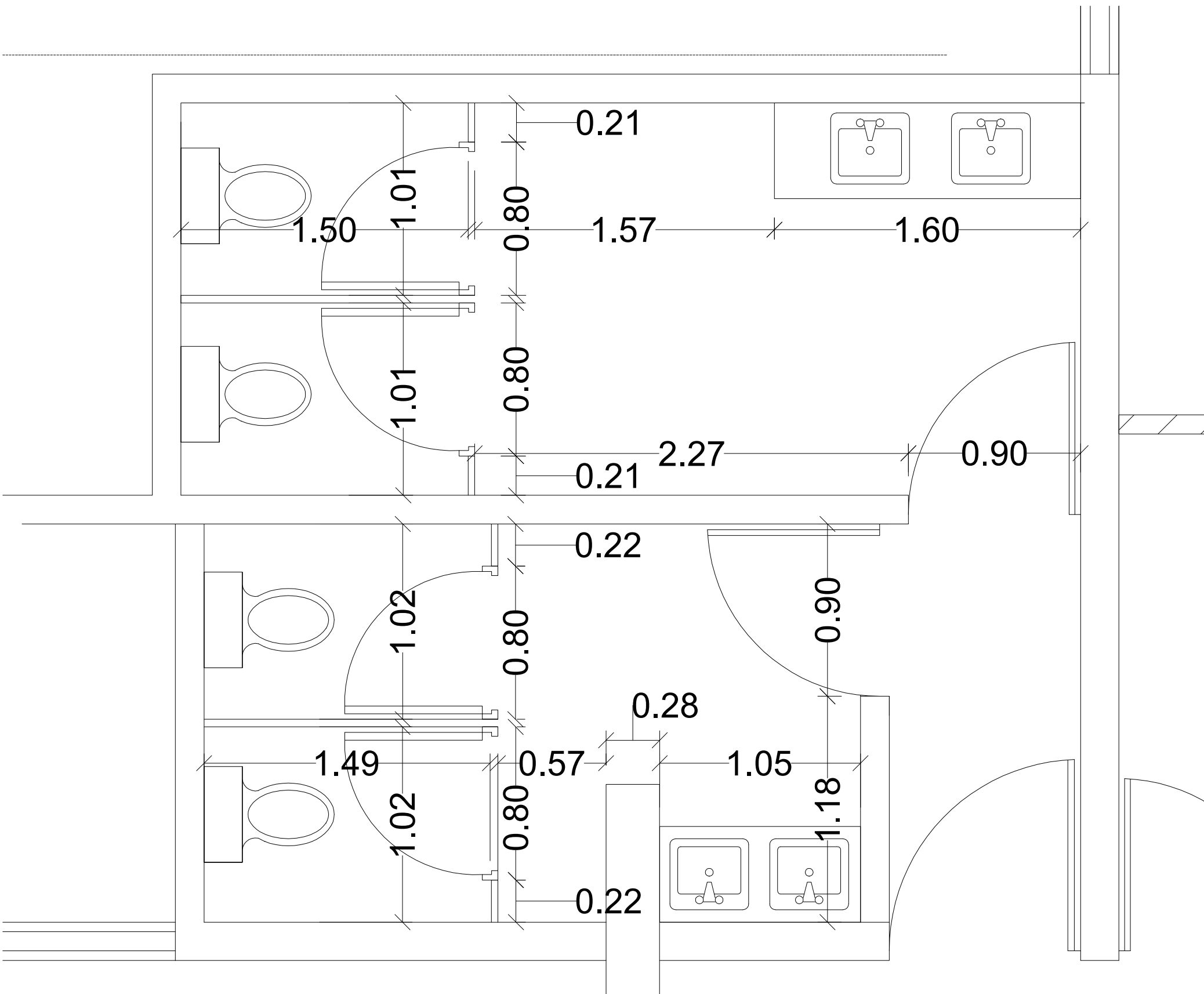
PLANTA DIMENSIONADA ACTUAL BAÑOS MAGISTRADOS ESCALA: 1:50
