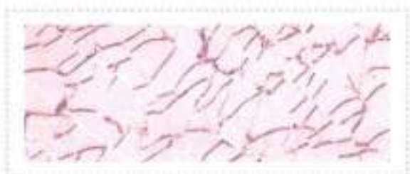
Patrón de fragmentación de cristal templado
