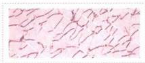
Patrón de fragmentación de cristal templado
