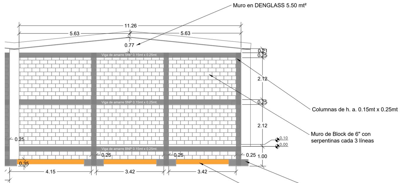
PLANTA DETALLES MUROS DE BLOCK DE 6" 1
