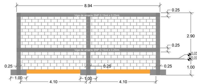
PLANTA DETALLES MUROS DE BLOCK DE 6" 3
